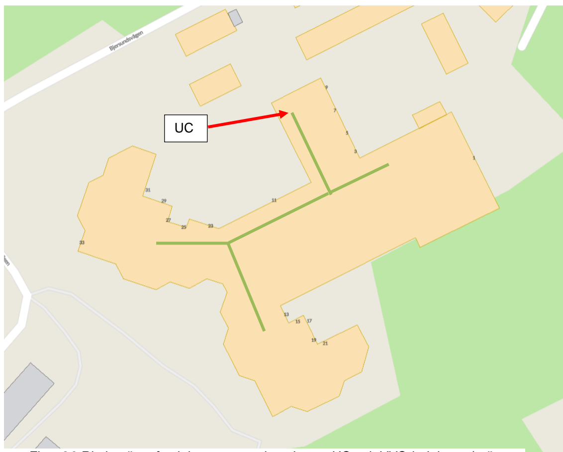
Figur 26 Ritning över fastigheten samt placering av UC och VVC-ledningar (gröna linjer).
